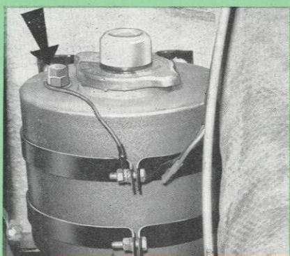
Soupape de dégazage du circuit hydraulique de servo-direction sur réservoir (cab. semi-avancée)
